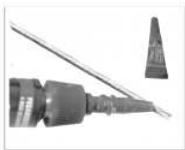
Poner una gotita de super-glue(suministrado por mas de 50 colgadores) en la punta del cable para que no se deshile
