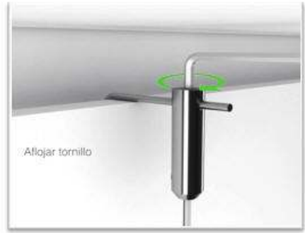
aflojar el freno (con 1/2 vuelta basta)
