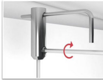
apretar el tornillo al llegar al nylon dar solo 1 vuelta mas
