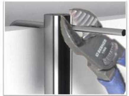
si lo considera necesario y va a estar en el mismo lugar u otro de igual grosor, PUEDE CORTAR el sobrante, Si lo va a usar en lugares diferentes NO LO CORTE
